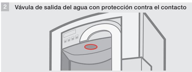
1 Mediante la desinfección térmica integrada, todas las tuberías de paso del agua, los módulos de calentamiento y refrigeración, así como el filtro Hy-Protect y la válvula de salida del agua, se desinfectan automáticamente y periódicamente, sin adición alguna de sustancias químicas.
