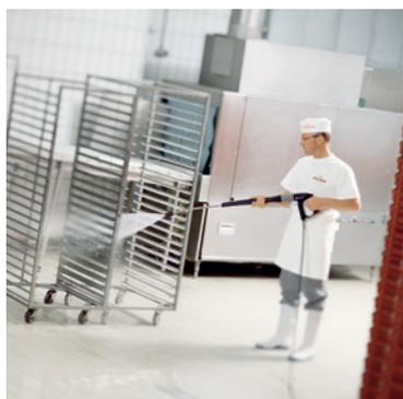
Hasta doce usuarios pueden limpiar con agua a alta presión en los distintos puntos de toma. No es necesario transportar un equipo móvil a cada lugar de utilización. También desaparecen los costes de varios equipos. Independientemente de la tarea de limpieza, la limpiadora estacionaria de alta presión está instalada en un lugar fijo. Esto permite a las empresas y municipios, por ejemplo, cubrir las tareas de limpieza más variadas con un solo módulo HDC.
