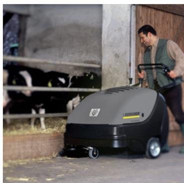
También en las barredoras de conducción manual es importante dar con la combinación correcta. Los cepillos cilíndricos blandos, duros o antiestáticos permiten adaptar cada máquina a su ámbito de aplicación. Los nuevos filtros garantizan un aire siempre limpio.
